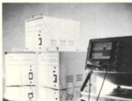
Afb. 1. De nieuwe EVS-serie stabilisatoren van Ling Dynamic Systems met een rendement van 98%.
